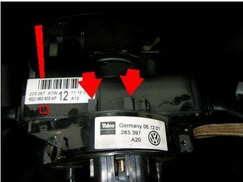
Adesso tocca al devioluce, vediamo che è fissato tramite un anello che viene allentato svitando la vite esagonale. Una volta svitata un po', non completamente, tiriamo l'asticina di sicurezza della presa T41 e sfiliamo il devioluce quasi contemporaneamente alla asticina. Vedrete che con un po' di pazienza verrà via.
